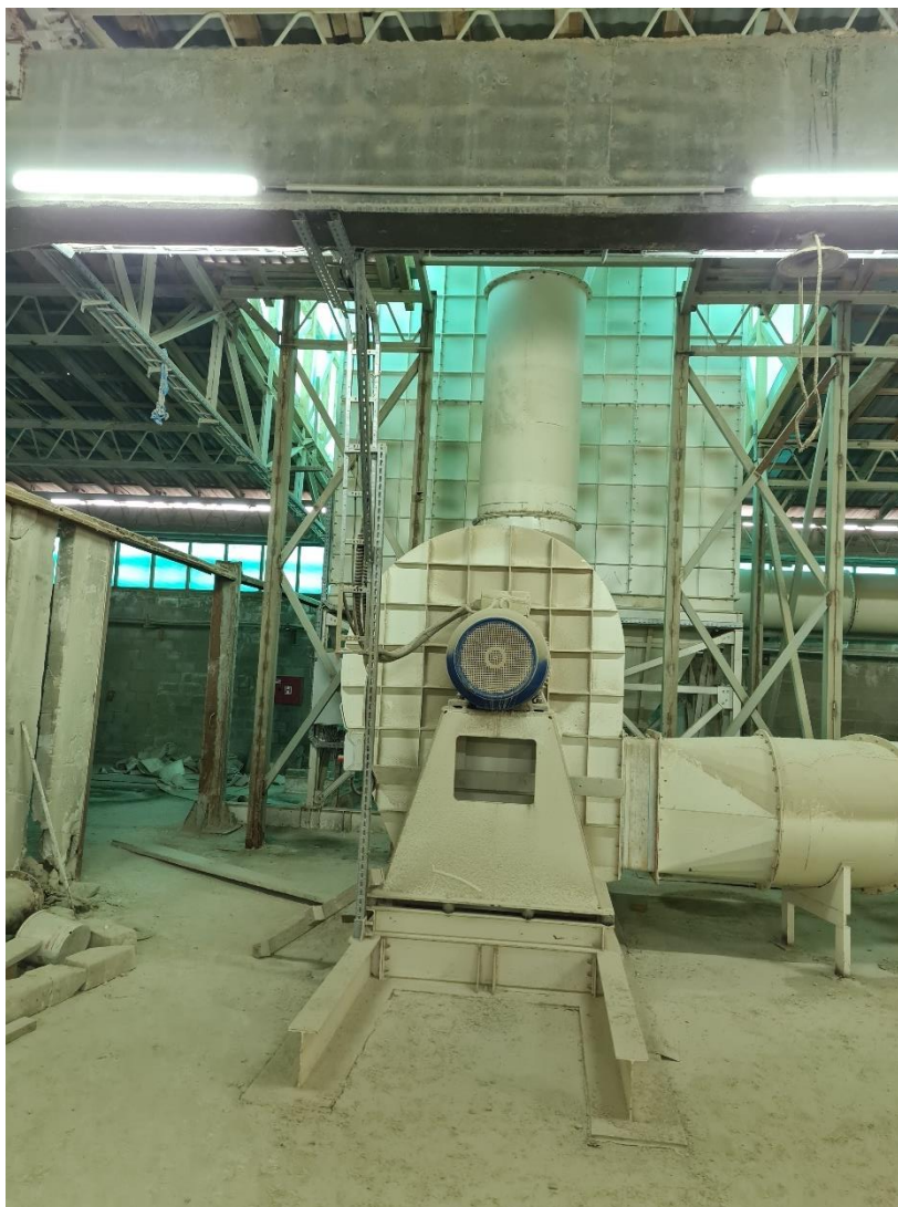
Слика 6. Систем за отпрашивање бр. 4 (С4)
